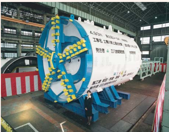
使用したシールドマシン(φ4.93泥土圧式シールド)
